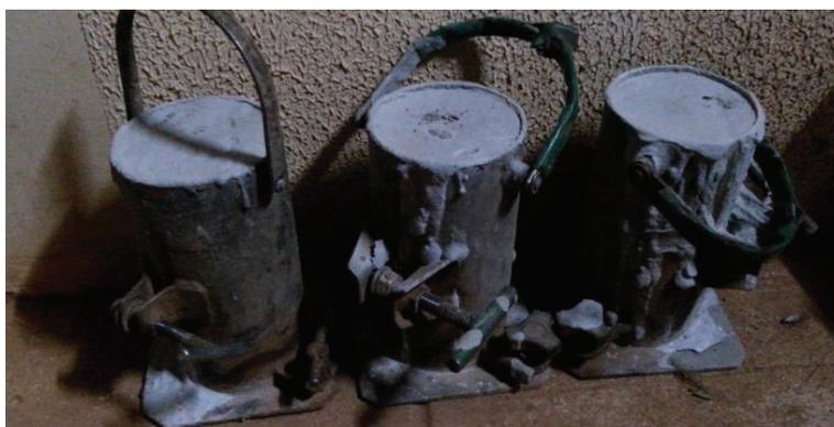
Após 7 (sete) dias de cura, os corpos de prova foram rompidos em prensa hidráulica para a verificação da resistência à compressão (FIGURA 5).
