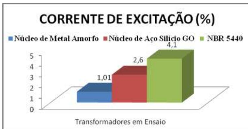
Figura 2. Corrente de Excitação (%) do transformador de 5KVA.
