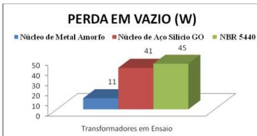
Figura 3. Perdas a vazio do transformador de 5KVA.
