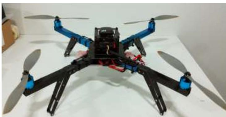
Figura - VANT do tipo quadrotor
