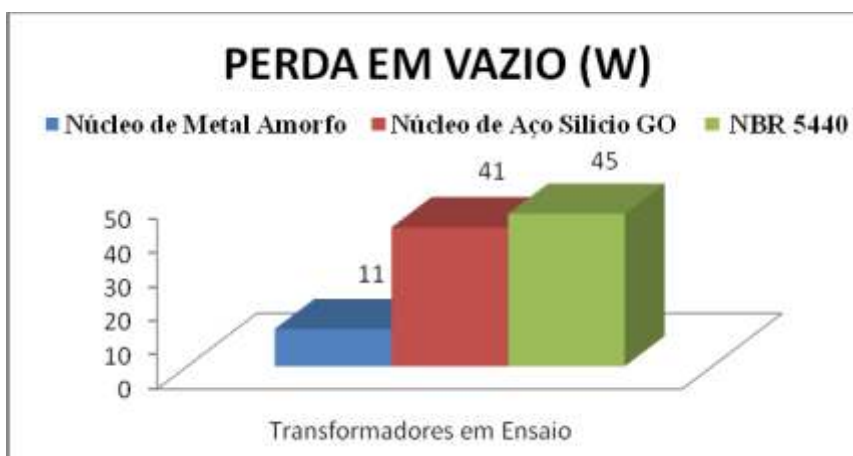
Figura 3. Perdas a vazio do transformador de 5KVA.
