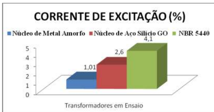
Figura 2. Corrente de Excitação (%) do transformador de 5KVA.
