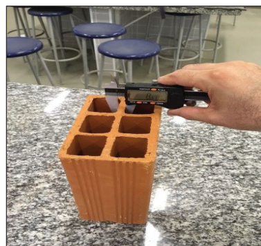
Figura 10 - Detalhes dos ensaios de análise das paredes externas (d) e septos (e) dos blocos cerâmicos.
