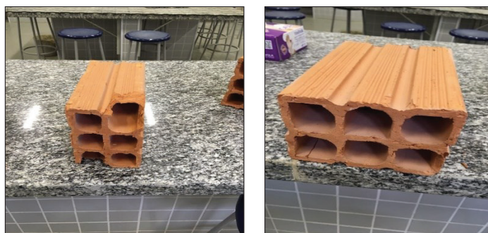
Figura 8 - Verificação das características em relação aos defeitos visuais dos blocos cerâmicos.
