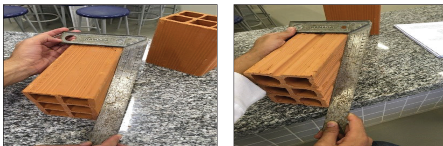
Figura 12 – Detalhes dos ensaios de análises das planezas das faces dos blocos cerâmicos.
