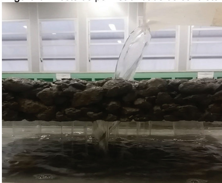
Figura 6 - Teste de permeabilidade do concreto.
