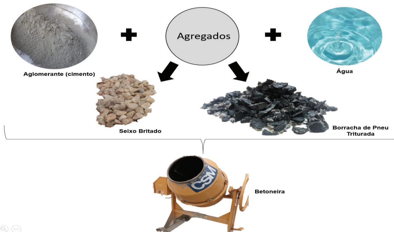
Figura 3 - Materiais e método utilizado para a dosagem do concreto poroso.
