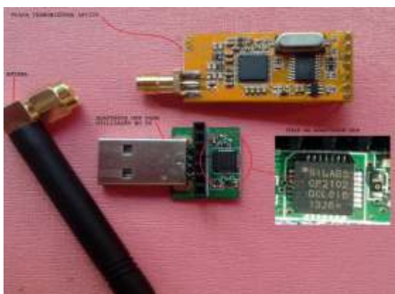
Figura 4 - Transmissor APC220 com acessórios.
