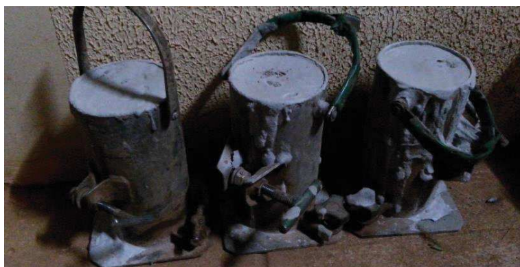
Figura 4. Concreto celular moldado em cilindro.
