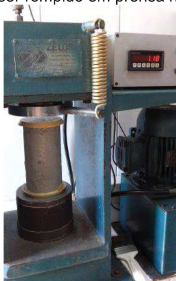
Figura 5. Corpo de Prova a ser rompido em prensa hidráulica.
