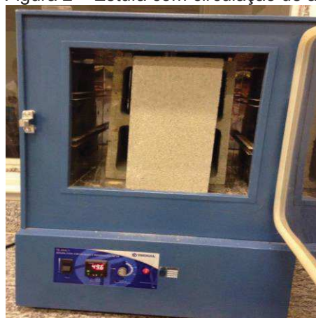
Figura 2 – Estufa com circulação de ar.
